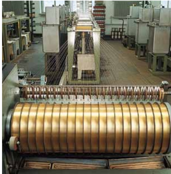
Galvanikanlage zum Vergolden von Gespinsten (Werkfoto LEONI Draht Weißenburg)
