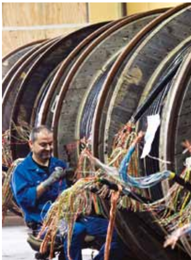
Qualitätskontrolle bei einem über 2000-paarigen Fernmeldekabel. Bild: Bayka
